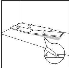
Denken Sie daran, entlang des gesamten Umfangs des Raumes die Randabstandshalter zu verwenden, um eine Randabstände von 8 mm einzuhalten. Uniclic kann auf zwei verschiedene Arten verlegt werden. Die bevorzugte Methode ist Methode A (Einwinkeln):
