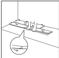
Platzieren Sie nun BEIDE Hände wie in der Abbildung gezeigt nahe an der Fuge und ziehen Sie die Längskante der Diele in Ihre Richtung.
